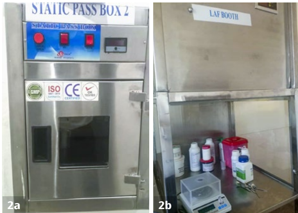
Figure 2 Unité de production de collyres du Ruharo Mission Hospital. a. Boîte de passage statique pour stérilisation aux UV. b. Hotte à flux laminaire pour la pesée des ingrédients et matériaux dans des conditions d'asepsie.
