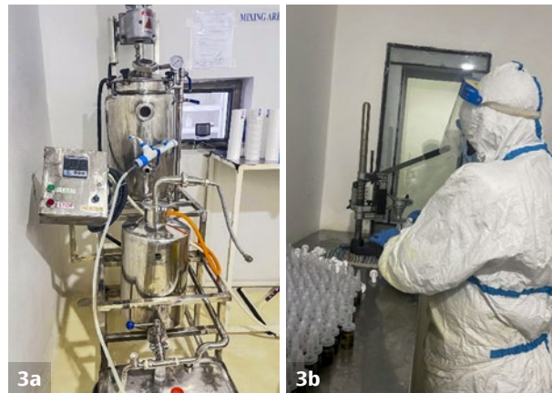
Figure 3 Unité de production de collyres du Ruharo Mission Hospital. a. Unité de traitement par lots. b. Boucheuse manuelle.
