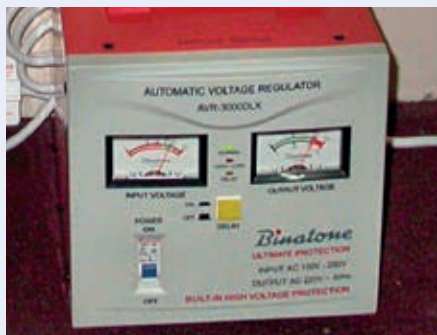
Figure 2. Régulateur de tension
