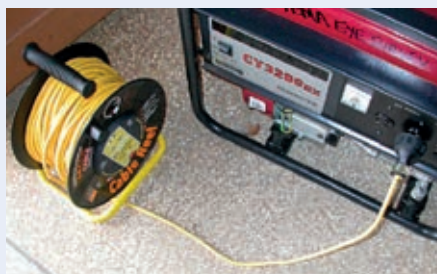
Figure 1. Branchement de l'enrouleur électrique au groupe électrogène. Déroulez le câble avant de brancher le régulateur de tension sur la prise de l'enrouleur électrique.
