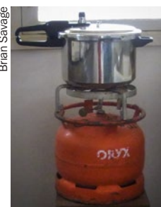
Figure 5. Autocuiseur domestique et brûleur à gaz monté sur une bonbonne
