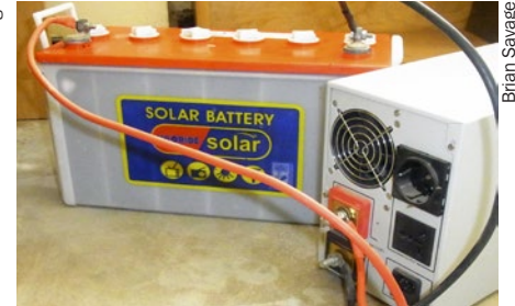
Figure 2. Onduleur, connecté à une batterie d'accumulateurs au plomb (rechargeable à l'énergie solaire ou sur le secteur)
