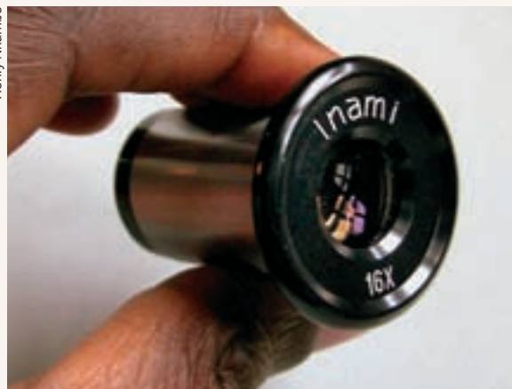
Figure 1. Oculaire supplémentaire d'une lampe à fente (vue de la partie proximale)
